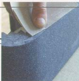
Korrekturen oder kleinere Ausbesserungen ganz einfach mit Schleifpapier bearbeiten.
