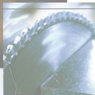
Die Verarbeitung von Varicor®-Platten erfolgt mit hartmetallbestückten Werkzeugen der Holzverarbeitung.
