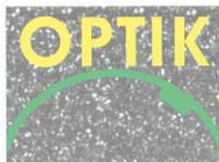
Varicor®-Colorline setzt farbige Akzente, z.B. mit einem Firmenlogo. Dazu werden entsprechende Formen ausgefräst, mit flüssigem Colorline aufgefüllt und nach dem Ausbärten geschliffen.
