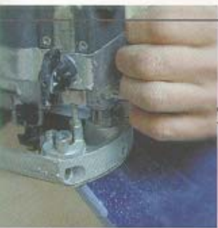
Mit einer Handoberfräse lassen sich z.B. Kanten profilieren und Nuten fräsen.
