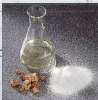
Einfache Rohstoff-Formel: 2/3 natürlicher, mineralischer Füllstoff, 1/3 hochwertige, gebundene Harze
