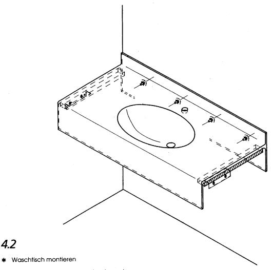
Wand-Auflagewinkel nur unter den unter-geklebten Auflagehölzern am Waschtisch mit den mitgelieferten Kreuzschlitzschrauben 4 x 19 mm befestigen
